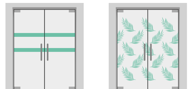
Przykłady oznakowania przegród i ścian transparentnych.
